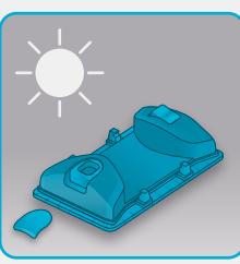
**FR** Remplir environ 1/3 du réservoir d'eau en vinaigre blanc ménager et le laisser s'écouler en statique dans l'évier jusqu'à ce qu'il se vide. Rincer le réservoir à l'eau. Laisser sécher A renouveler chaque mois.
