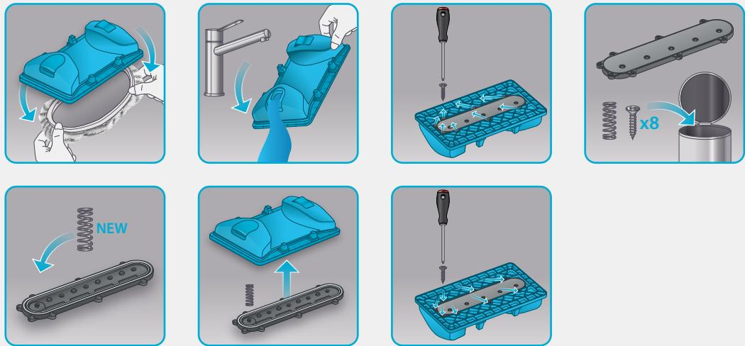
**FR** Retirer la lingette. Vider le réservoir d'eau. Enlever les 8 vis du système de distribution d'eau, remplacer le ressort et le système de distribution d'eau, revisser le système de distribution d'eau au réservoir.
